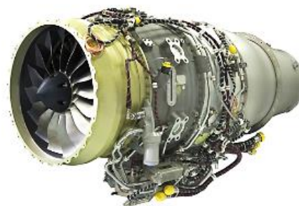
GEと共同開発のHF120エンジン HPより
